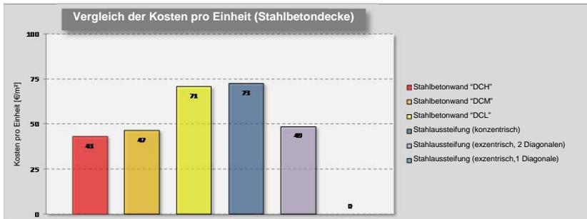
**VERGLEICH ZWISCHEN STAHLBETONWAND UND STAHLAUSSTEIFUNG (B=4m; H=6m; V<sub>b</sub>=2000 kN)**
