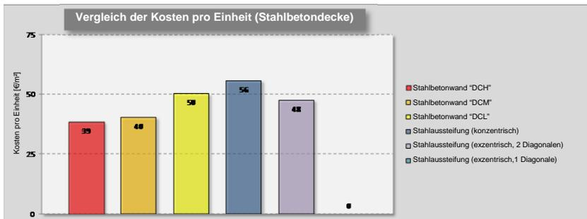
**VERGLEICH ZWISCHEN STAHLBETONWAND UND STAHLAUSSTEIFUNG (B=4m; H=4m; V<sub>b</sub>=2000 kN)**
