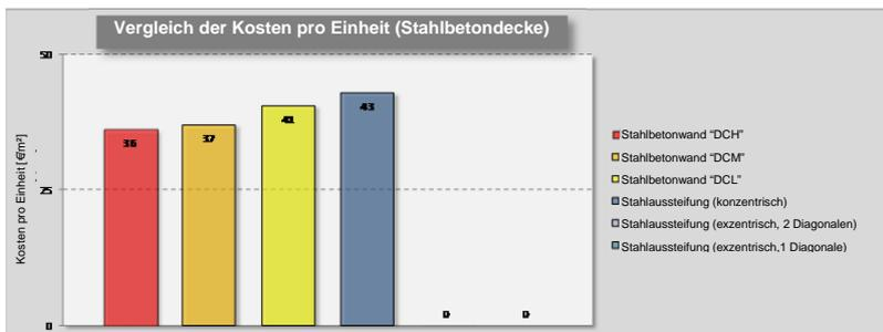
**VERGLEICH ZWISCHEN STAHLBETONWAND UND STAHLAUSSTEIFUNG (B=8m; H=6m; V<sub>b</sub>=2000 kN)**
