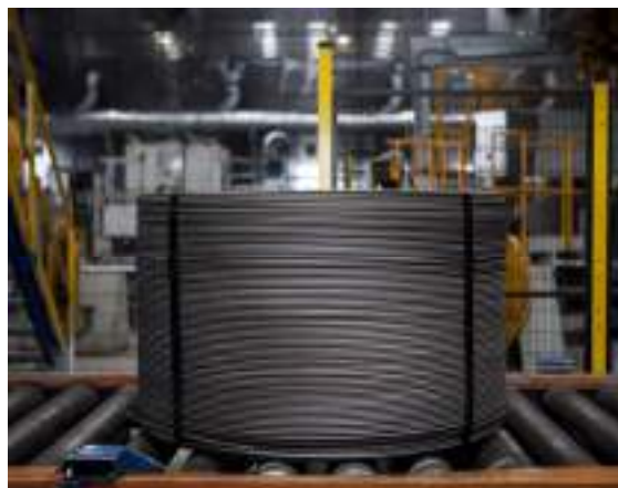
Figura 3.3 - Impianto rotolo ribobinato
