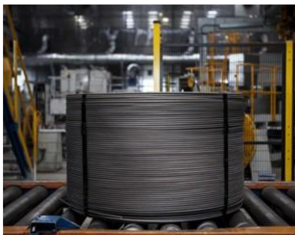
Figura 3.3 - Impianto rotolo ribobinato
