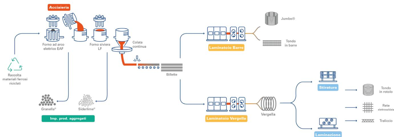
Figura 8.2 - Rappresentazione schematica del processo produttivo di Ferriere Nord S.p.A. di Osoppo
