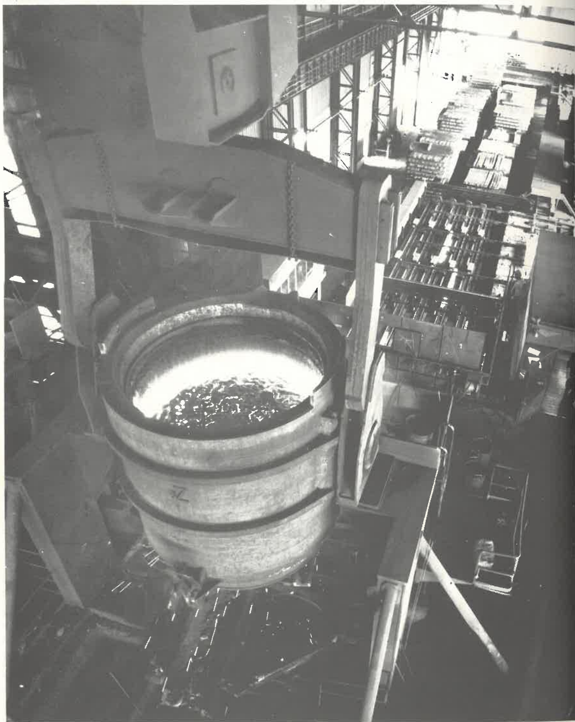
Figura 2: L'impianto di colata continua dell'Acciaieria Sideros. Le billette, dai piani di raccolta, vengono trasferite direttamente al forno del laminatoio.
